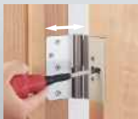
左右調整 (左右調整範圍: ±2 mm)
