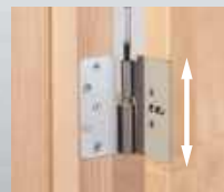
上下調整 (只有下鉸鏈) (上下調整範圍: ±2 mm)
